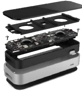
Figura 2.2: Il sensore Leap Motion esploso[4]
